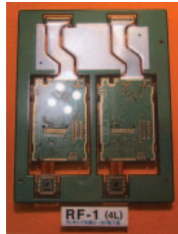
写真3 リジッドフレックスプリント版採用事例 （ご提供：日本シイエムケイ（株）殿）
